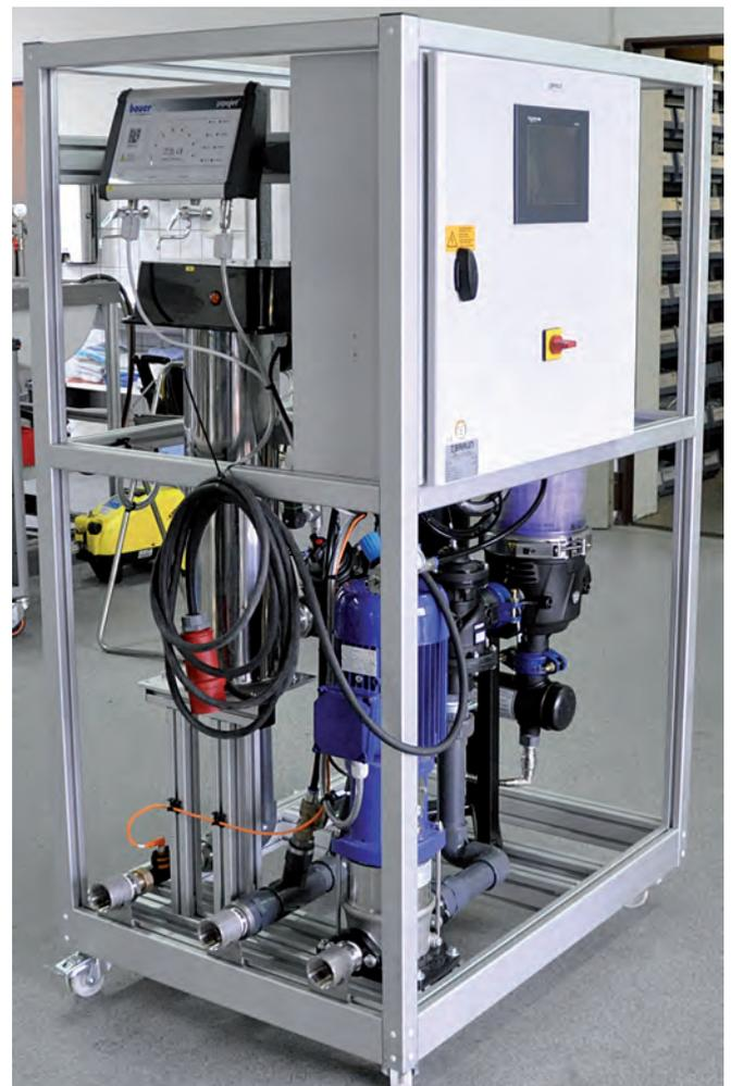
Wasseraufbereitungsanlage: geregelte Pumpe, physikalische Wasseraufbereitung, automatische Feinfiltration, UV-Behandlung, Monitoring.
